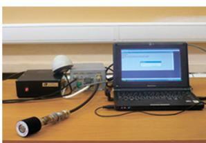
Спутниковый радиотерминал для передачи гидрометеорологической информации
