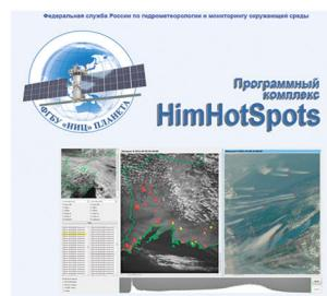
ПК тематической обработки измерений аппаратуры AHI (КА Himawari-8) предназначен для детектирования точек вероятного возгорания с возможностью их редактирования в интерактивном режиме.
