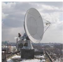
ПК-3,5 – аппаратно-программный комплекс (АПК) приема и обработки данных с полярно-орбитальных КА серий Метеор-М, EOS, NOAA в X и L-диапазонах. Диаметр антенны 3,5 м.
