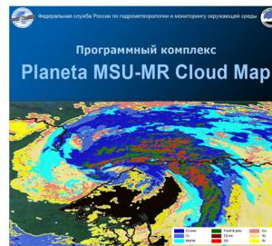
ПК тематической обработки предназначен для автоматического дешифрирования облачности и последующей ее классификации с выделением облачности конвективного характера по данным аппаратуры МСУ-МР (КА серии Метеор-М).
