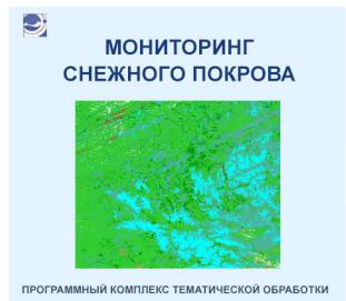
ПК тематической обработки предназначен для оценки распределения снежного покрова по высотным зонам в пределах речных бассейнов, создания карт снежного покрова отдельных регионов России, территории бассейнов рек и водохранилищ по данным аппаратуры MODIS (КА Terra), VIIRS (КА Suomi NPP и NOAA-20).
