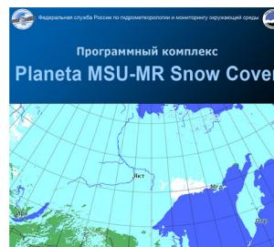
ПК тематической обработки предназначен для построения 8-дневных композитных карт распределения снежного покрова по данным аппаратуры МСУ-МР (КА серии Метеор-М).
