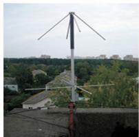
ПС-LRPT – АПК приема и обработки данных с полярно-орбитальных КА серий Метеор-М, Metop в международном формате LRPT в VHF-диапазоне.
