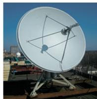
СПОИ-2L – станция приема и обработки данных с полярно-орбитальных КА серий Метеор-М, NOAA, Metop в L-диапазоне. Диаметр антенны 2 м.
